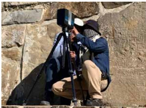
図4 モンテ・アルバン遺跡、建造物Jの線刻画の3Dスキャナーによる計測模様。
