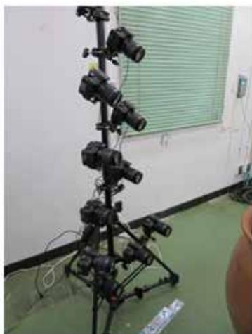
図2 SfM計測システム
